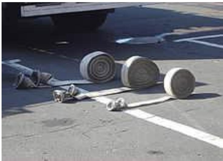
Пожарный рукав — гибкий трубопровод для транспортирования огнетушащих веществ, оборудованный пожарными соединительными головками.
